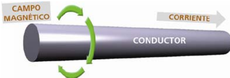
Conductor que lleva una corriente eléctrica y genera un campo magnético.
